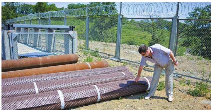
■ Геомембрана для укладки в чашу золоотвала «Зеленая балка» (июль 2015 г.)
